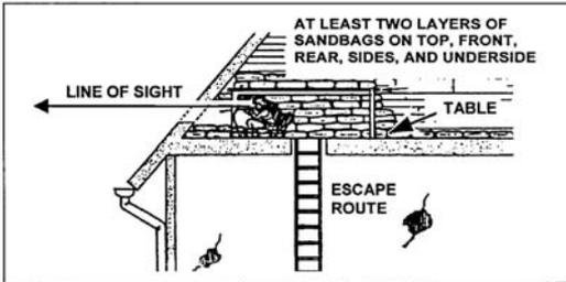
Figure 071-326-0550-7. Reinforced position
