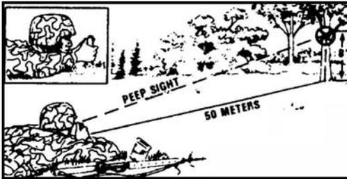
Figure 071-325-4425-9. Aiming slit-type peep sight
