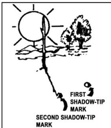
Figure 071-329-1018-2. Second shadow-tip mark
